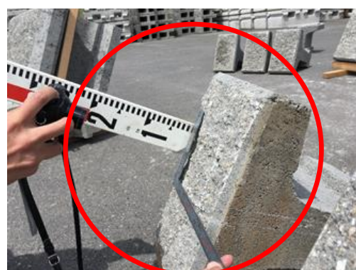
写真-21 L型定規の正しい設置例
