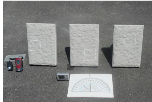
写真-10 小型ブロック（ 0.25\text{ m}^2 以下/個）の設置例
