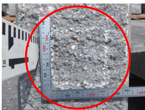
写真-21 L型定規の正しい設置例
