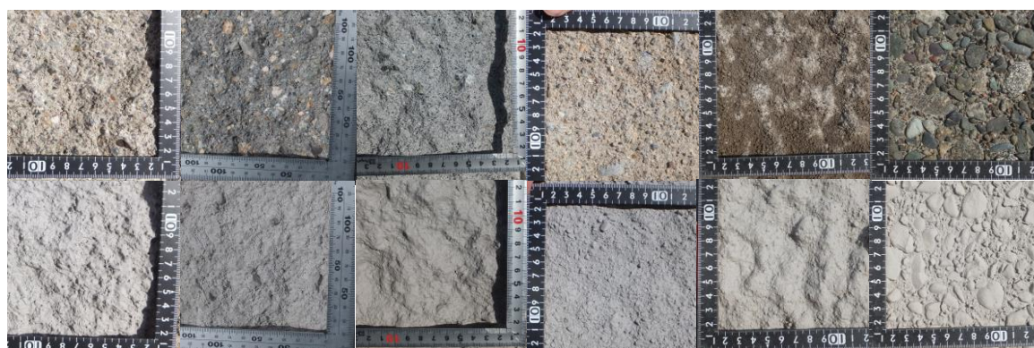
写真-28 半割、砂面、洗出し仕上げの例（下段は色のばらつきをなくした状態）
