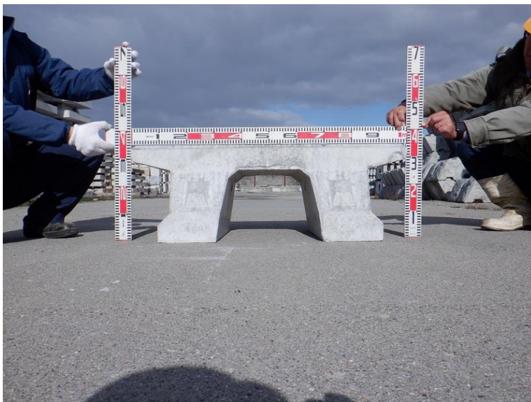
写真-8 積みブロックの上面の撮影例（ \pi 型：横幅1.0m×控長0.5mの場合）
