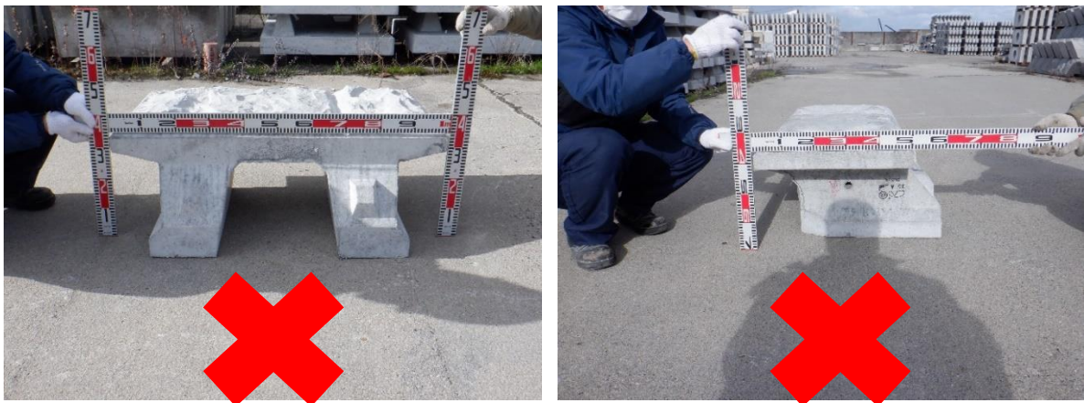
撮影高さが高く、控え材の形状を確認しにくい
