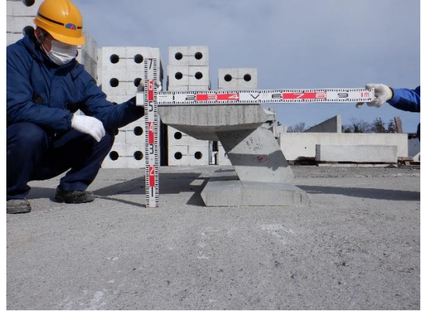
写真-10 積みブロックの側面の撮影例（左写真：π型、右写真：背面板型）
