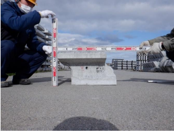
写真-10 積みブロックの側面の撮影例（左写真：π型、右写真：背面板型）
