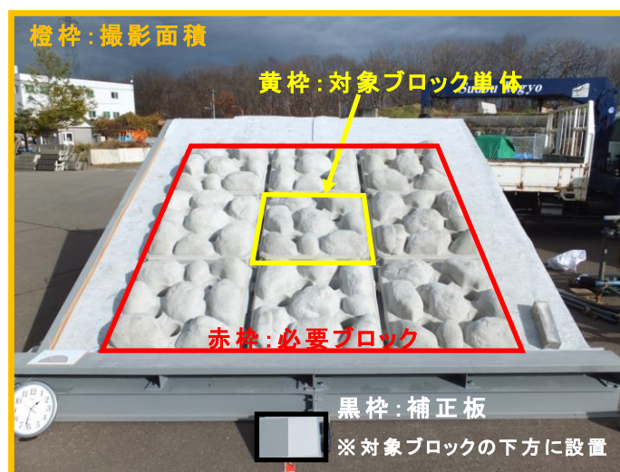
緩傾斜用護岸ブロック
