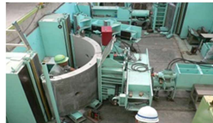
継手部の性能確認試験
