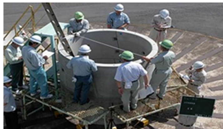
継手部の性能確認試験
