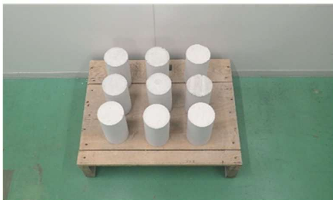
解説 図3.2.7 乾燥状況 (コンクリート試験室)
