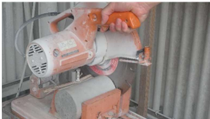
解説 図3.2.5 型枠底面側の供試体 切断状況
