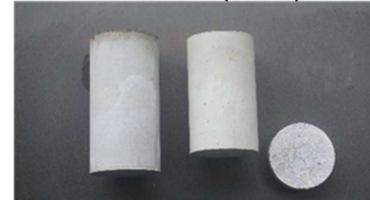
解説 図3.2.6 供試体の切断後状況 (25mm切断)
