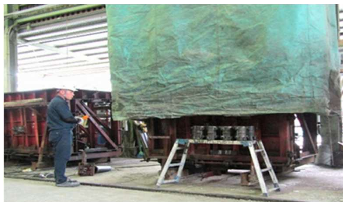
解説 図3.2.2 製品と同一養生状況 (養生シート)
