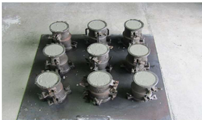
解説 図3.2.1 供試体9本製作/配合
