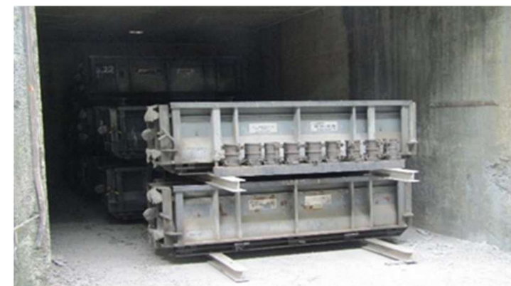
解説 図3.2.3 製品と同一養生状況 (養生槽)
