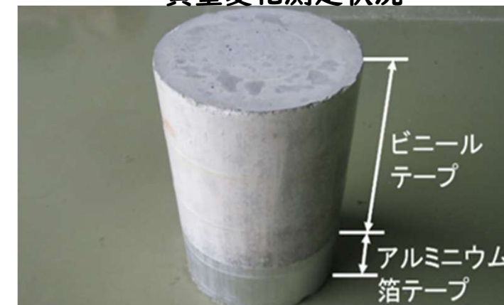
解説 図3.2.12 側面シール状況 例③ (アルミニウム箔+ビニールテープ接着) 公益社団法人 全国土木コンクリートブロック協会
