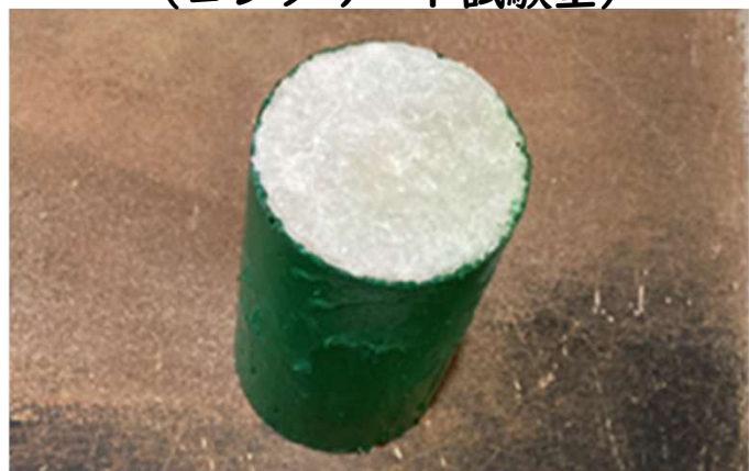
解説 図3.2.10 側面シール状況 例① (エポキシ樹脂塗装)
