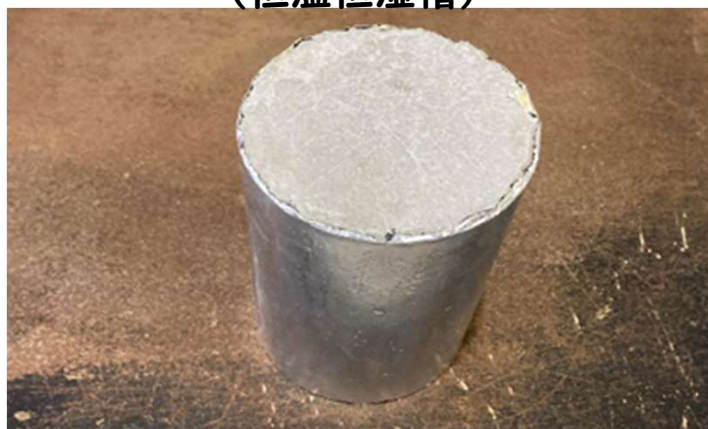
解説 図3.2.11 側面シール状況 例② (アルミニウム箔テープ接着)
